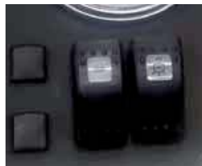
Huvudströmbrytaren för HR 442sc, HR 460sc och HR 480sc
