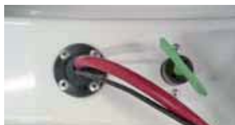
Huvudströmbrytaren för HR 442sc, HR 460sc och HR 480sc
